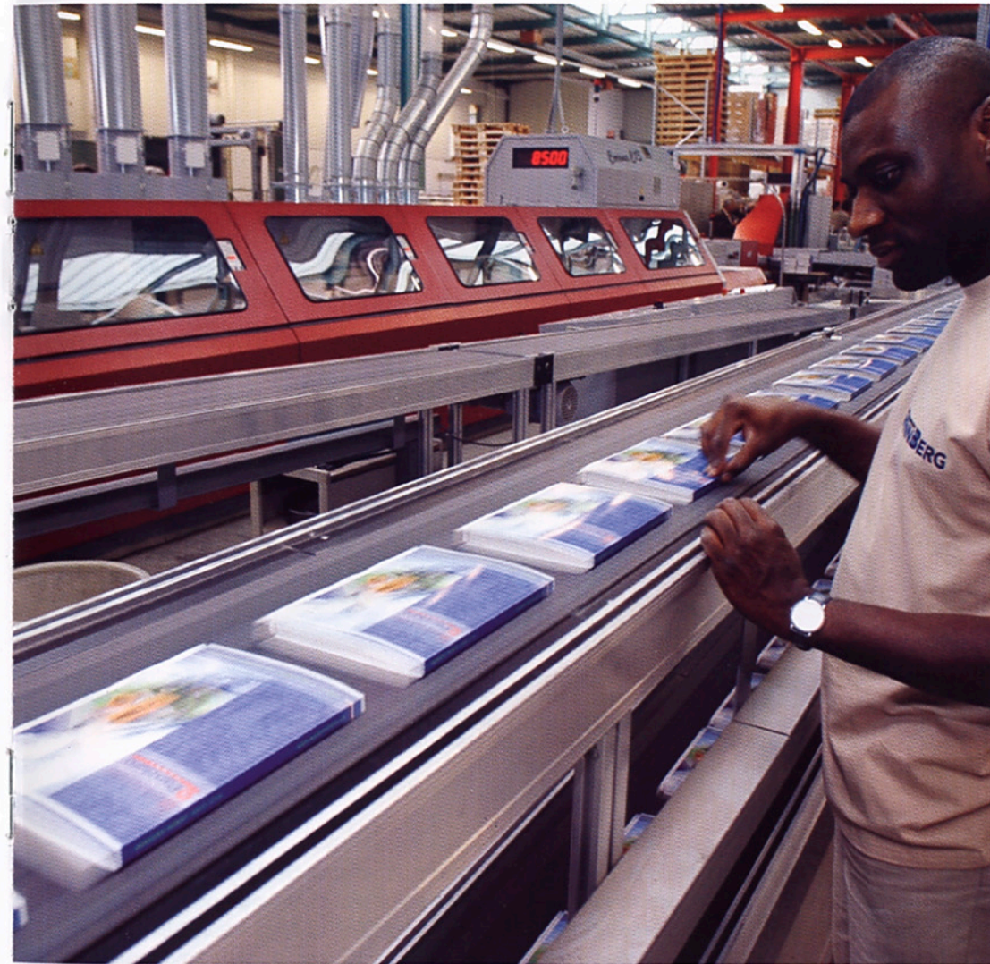
Pro Jahr produziert die Grossbuchbinderei Wennberg in Vaihingen an der Enz über 100 Millionen Kataloge – einen Grossteil davon auf zwei Klebebindelinien «Corona C13» von Müller Martini.
