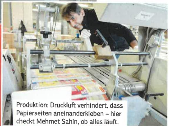
Produktion: Druckluft verhindert, dass Papierseiten aneinanderkleben – hier checkt Mehmet Sahin, ob alles läuft.
