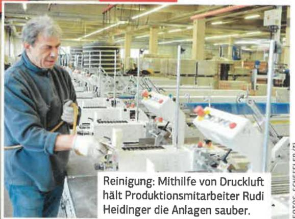
Reinigung: Mithilfe von Druckluft hält Produktionsmitarbeiter Rudi Heidinger die Anlagen sauber.
